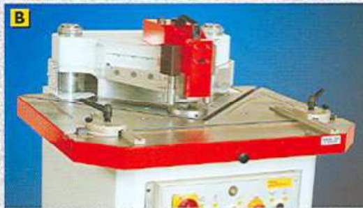
A - Punching head / Tête détachable de poinçonnage / Lochstanzkopf B - Slotting head / Tête à rainner / Drosselkopf
